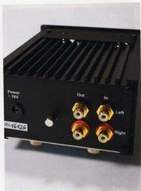
Pro-Jects rörbestyckade lilla RIAA har separat transformator och rejäla RCA-kontakter.
