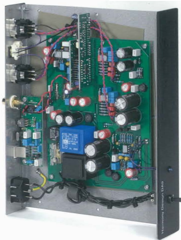
Harmonisches Nebeneinander: getrennte Trafos für analog und digital, symmetrische Signalverarbeitung, Cinch- und XLR-Ausgänge
