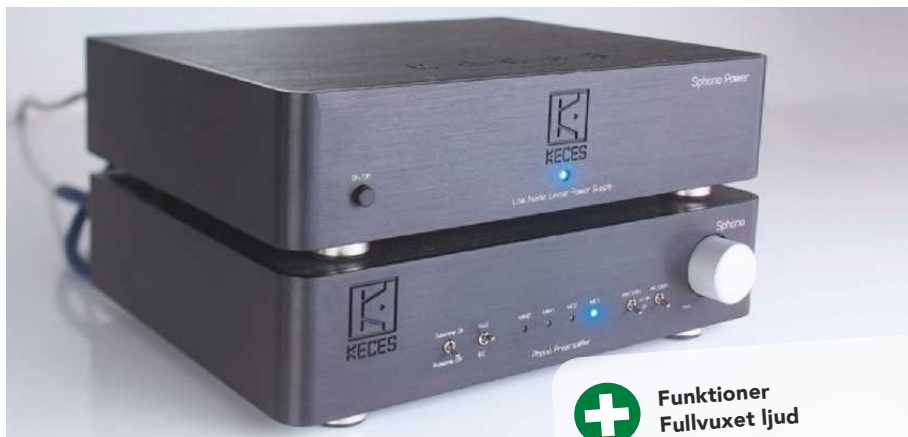
Keces Sphono och dennes dedikerade nätdel Sphono Power. Hela fyra par RCA-ingångar med sex DIP-switchar var, där man på ingångarna 1 och 2 kan justera MC-lasten mellan 55 ohm och 47 kOhm och på ingångarna 3 och 4 MM-lasten mellan 47 och 470 picofarad.
