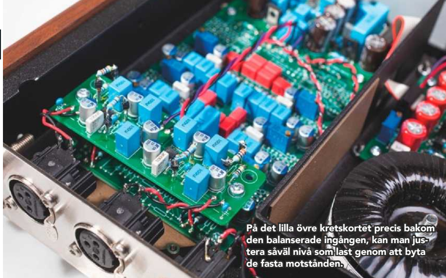
Testexemplaret levererades med balanserad ingång, förutom balanserade XLR- respektive obalanserade RCA-utgångar.
