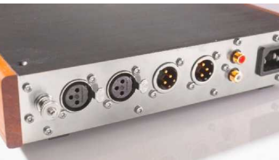
Testexemplaret levererades med balanserad ingång, förutom balanserade XLR- respektive obalanserade RCA-utgångar.
